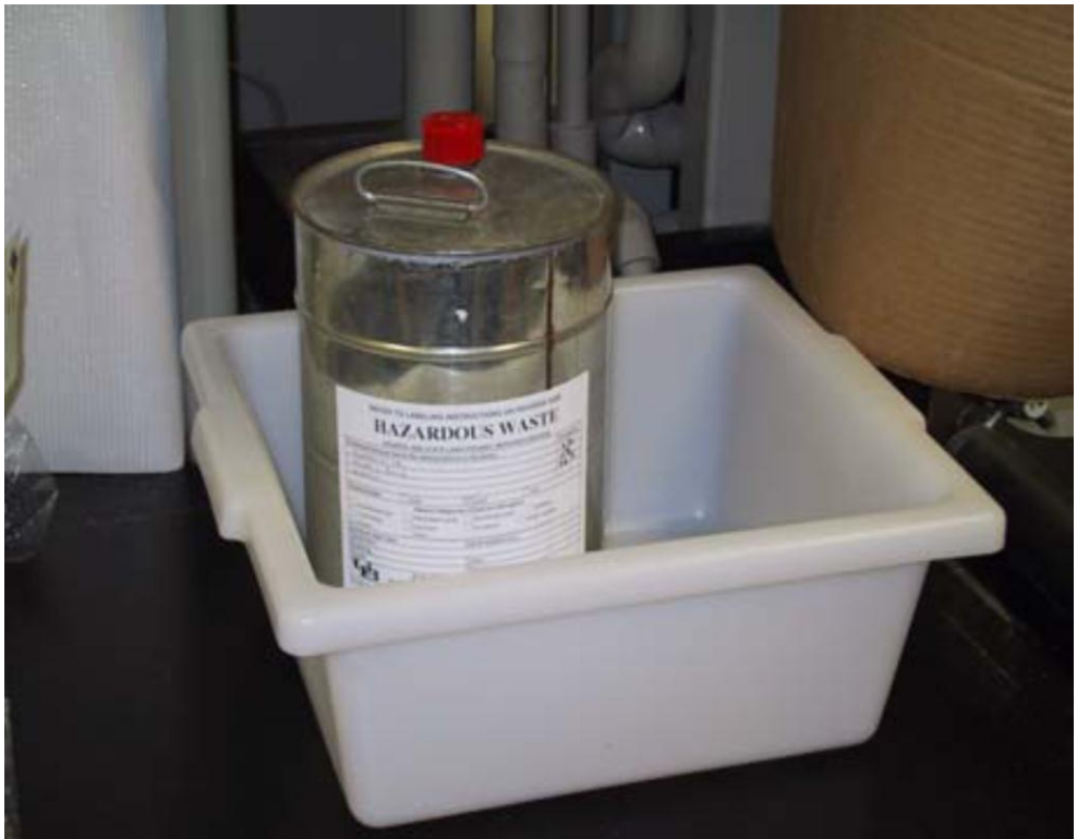
شکل ۸- محفظه ثانویه ظرف پسماند شیمیایی خطرناک
