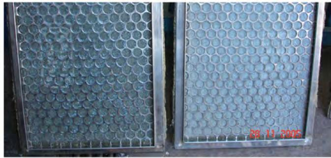
شکل ۷- تجمع ذرات بر روی سطح فیلتر کثیف (سمت چپ) و مقایسه با فیلتر تمیز (سمت راست)
