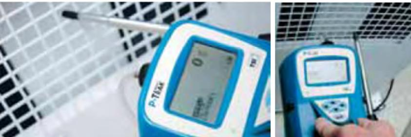
شکل ۱۳- استفاده از شمارشگر ذرات برای تعیین کارایی فیلتراسیون
