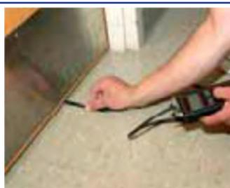
شکل ۱۲- مرحله ۴ قرار دادن لوله در زیر درب بسته برای اندازه گیری فشار نسبی بین ۲ فضا(۲۱)
