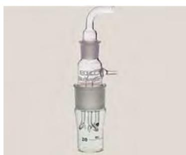
شکل ۵- بیوسمپلر مورد استفاده برای نمونه برداری بیوآئرولسیل
